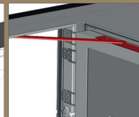
FERME-PORTE ENCASTRÉ AVEC BLOCAGE À 90°
